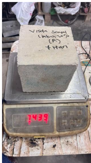
Gambar 4. Pembuatan benda uji dari sampel limbah 20% menjadi beton non-struktural
