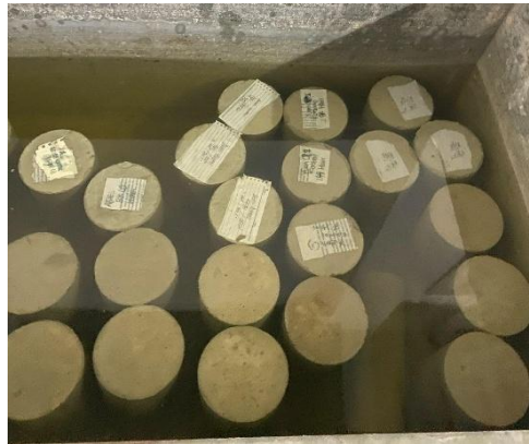
Gambar 5. Perawatan benda uji sampel beton
