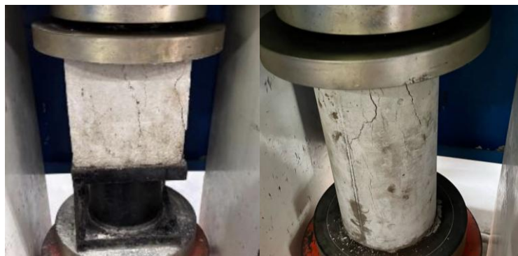
Gambar 6. Uji kuat tekan di laboratorium dari sampel limbah 20% menjadi beton non-struktural
