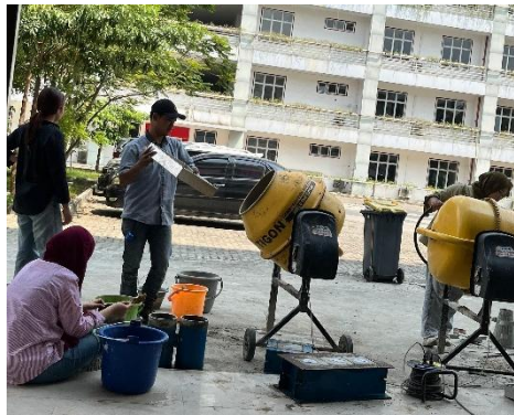
Gambar 5. Proses pembuatan prototipe batako, paving block dan benda uji beton precast saluran
