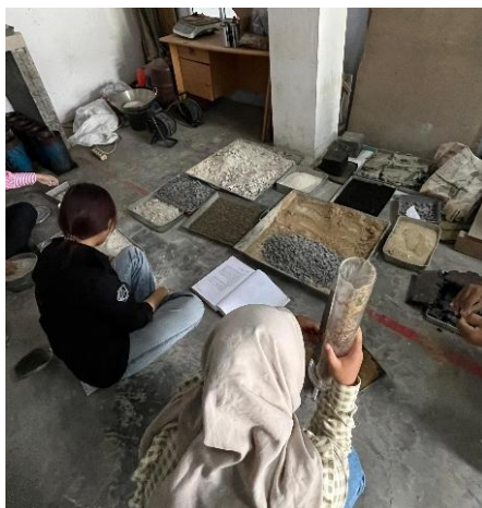
Gambar 4. Proses mix design material limbah untuk dibuat material pre-cast batako, paving block dan pre-cast saluran drainase maupun irigasi
