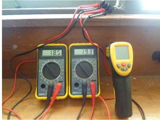
Gambar 2. Pengukuran tegangan dari solar panel
