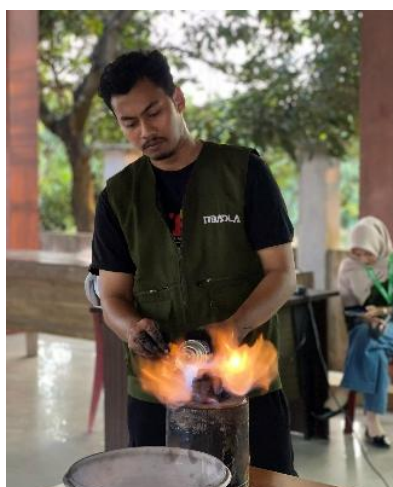
Gambar 4. Uji coba Pembakaran Briket dari Sekam Padi
