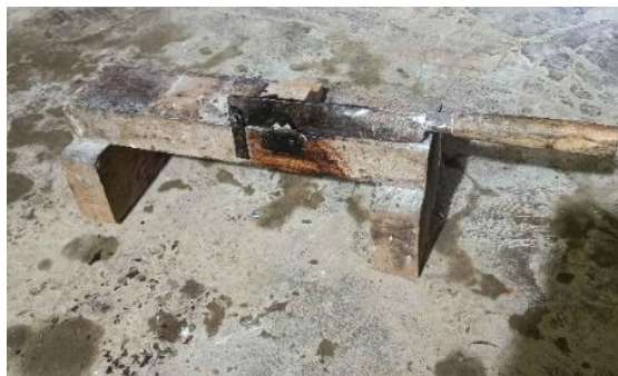
Gambar 3. Alat Pengupas Manual (Kacip)
