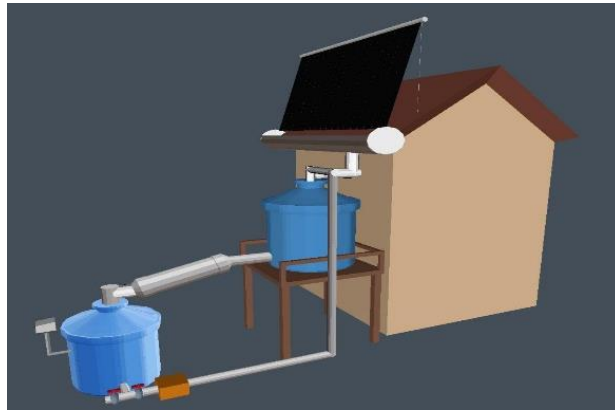
Gambar 9. Sketsa Sistem Pengolahan Air Hujan
