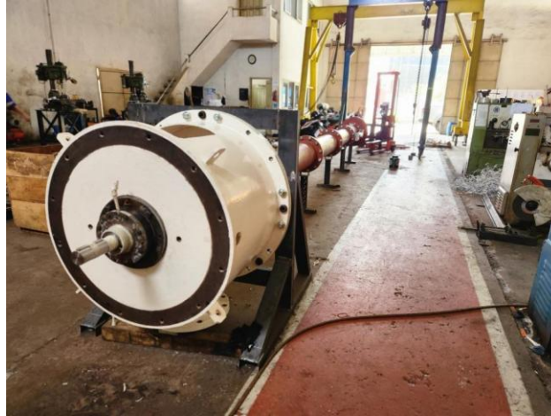
Gambar 2. Pompa air laut milik PLTU yang selesai diservice di bengkel mitra
